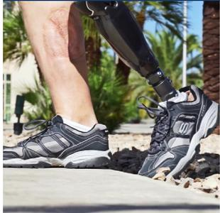
ALLUX 2 surveille en permanence la position et le mouvement du genou et réagit aux situations anormales. Par exemple : si la prothèse bute sur un obstacle pendant la phase pendulaire, le genou détectera cet événement indésirable et augmentera immédiatement la résistance hydraulique pour empêcher le genou de se dérober.
