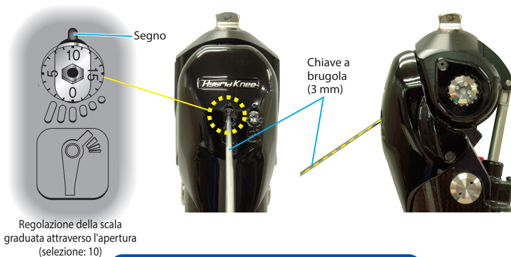
Figura 11 Come regolare la resistenza idraulica
