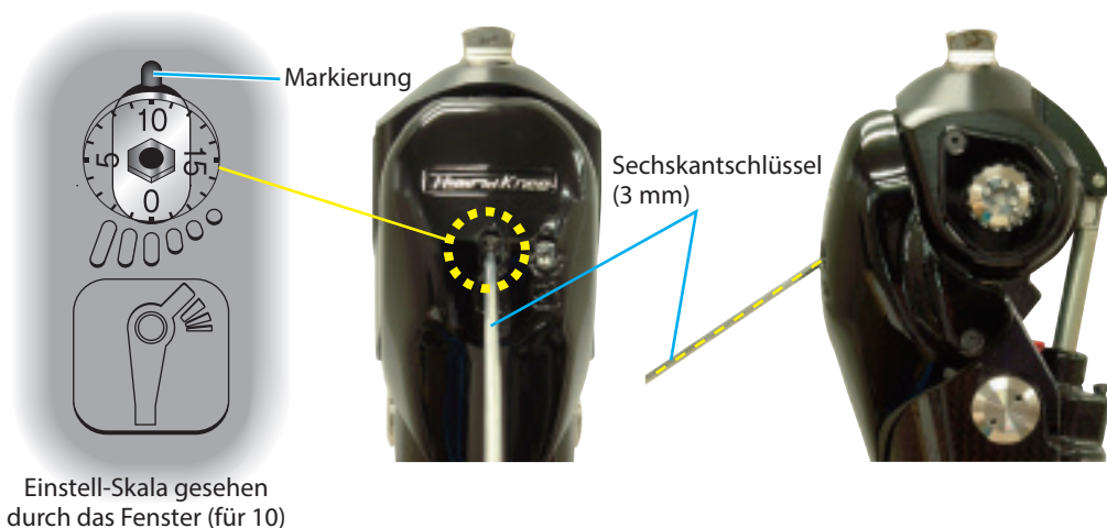
Abb. 11: Einstellen des hydraulischen Widerstands
