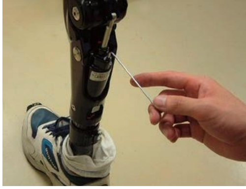
Şekil 16 Yastık Valfinin Sıkma Prosedürü
