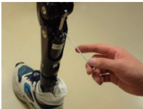
Fig. 16 Procédure de serrage du clapet d'amortissement
