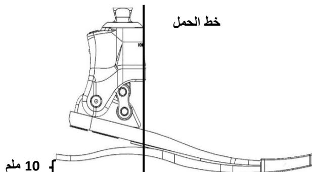
قبل تجربة الطرف الصناعي على المريض، وعند تركيب غلاف القدم بارتفاع 10 ملم تحت الكعب، أو وضع الجهاز في الحذاء المرغوب به، استخدم مطماراً أو مستوى ليزر للتأكد من أن خط الحمل على خط واحد مع الحافة الأمامية للأنبوب والهرم (انظر الرسم).
