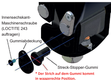
Fig. 19: Ersetzen des Streck-Stopper-Gummis
