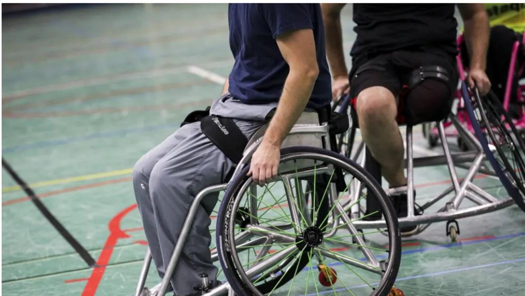
Les fauteuils de sport ont des dispositifs anti-basculer et sont souvent réglés sur mesure en fonction du handicap.
