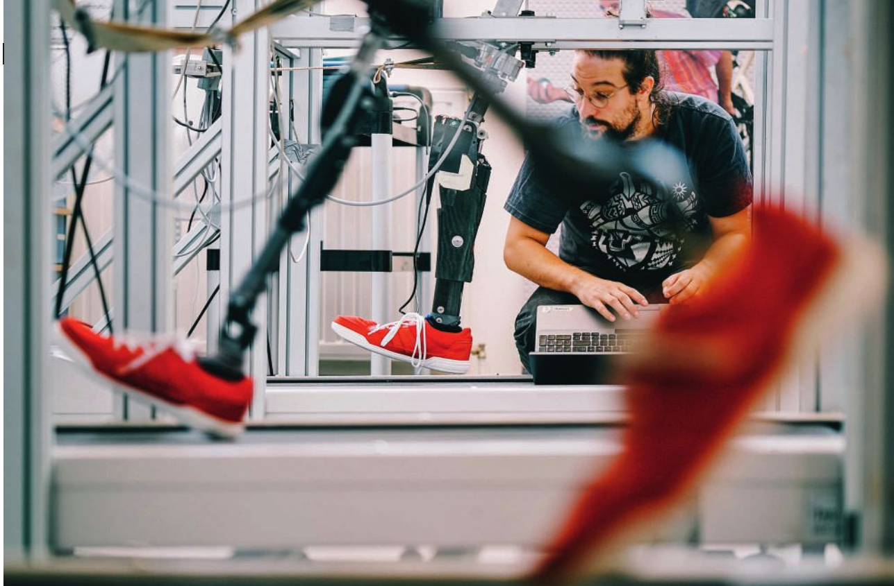
Sur le site de Seurre (Côte-d'Or), les équipes de Proteor, entreprise spécialiste des prothèses et orthèses sur mesure, conçoivent des équipements qui durent dans le temps. Ici, des « jambes » équipées d'un vérin hydraulique au niveau du genou.
